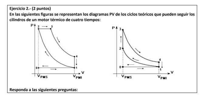
**a.** Explique de forma razonada cuál de estos ciclos termodinámicos pertenece a un motor de gasolina y cuál pertenece a un motor de gasoli. (0,5 puntos)
