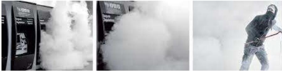
**Un sistema de seguridad antirrobo hace que la sala donde está instalado se llene de humo impidiendo la visibilidad del asaltante. (2 puntos)**
